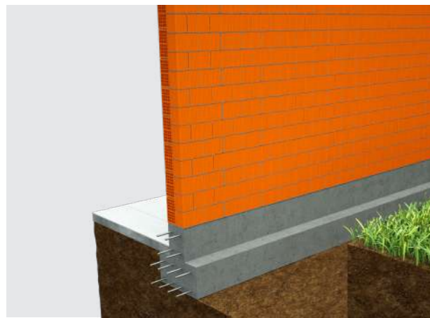
1 Fondazione in e.a. a sezione a T rovescia
