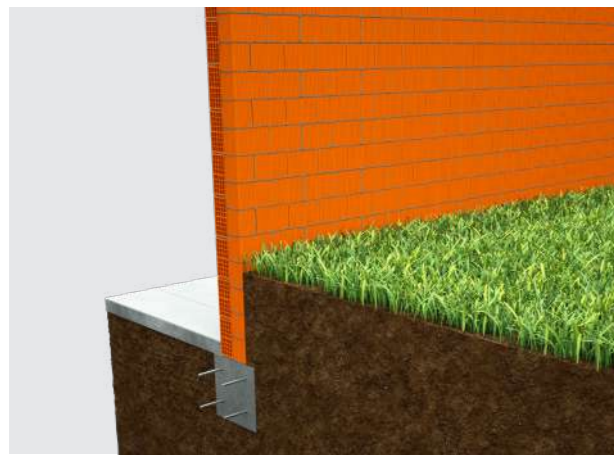
1 Scavo a scoprire il bordo della fondazione
