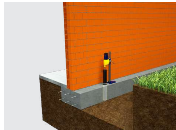
2 Carotaggio dell'ala di fondazione
